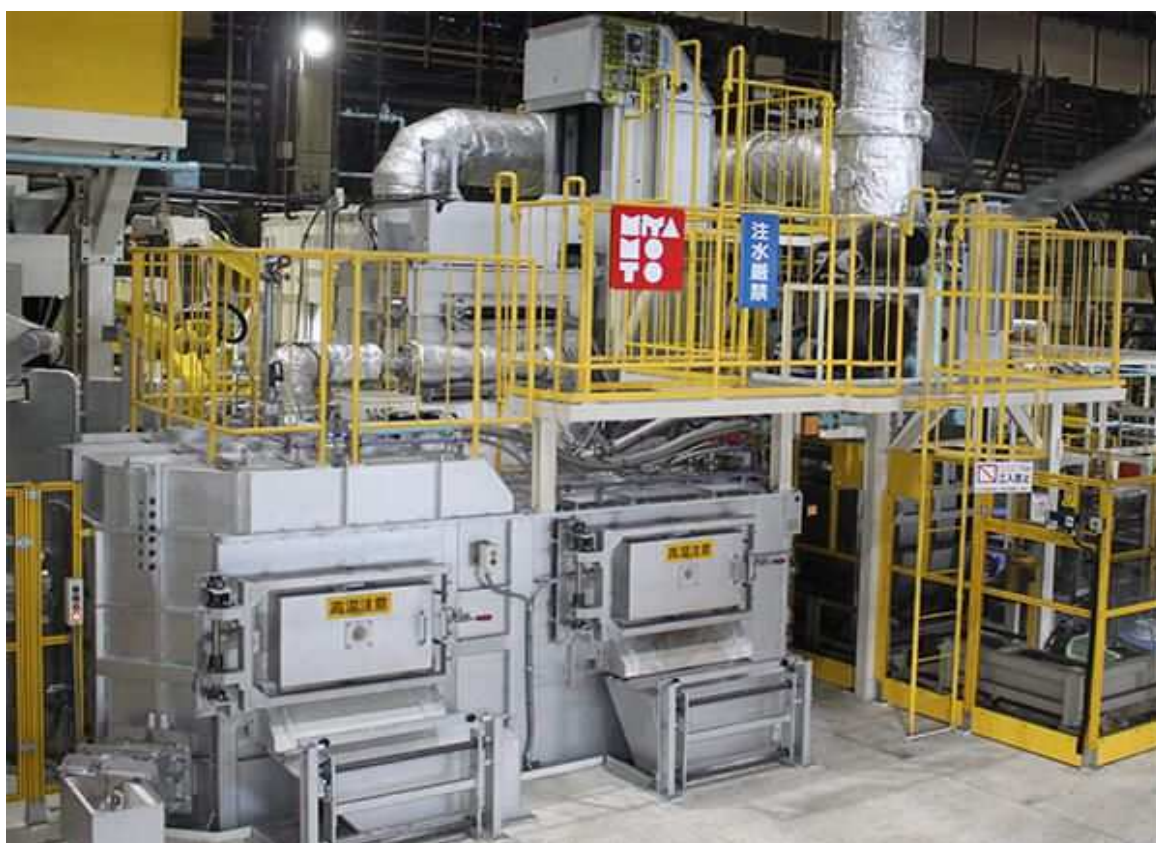
受賞の対象となった大型ダイカスト用高効率アルミニウム溶解炉
